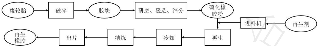
图 3 再生橡胶生产工艺流程图示意图
